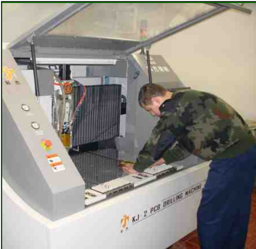
Обработка печатных плат на новом сверльно-фрезерном станке KJ-2 в гальваническом производстве 020
